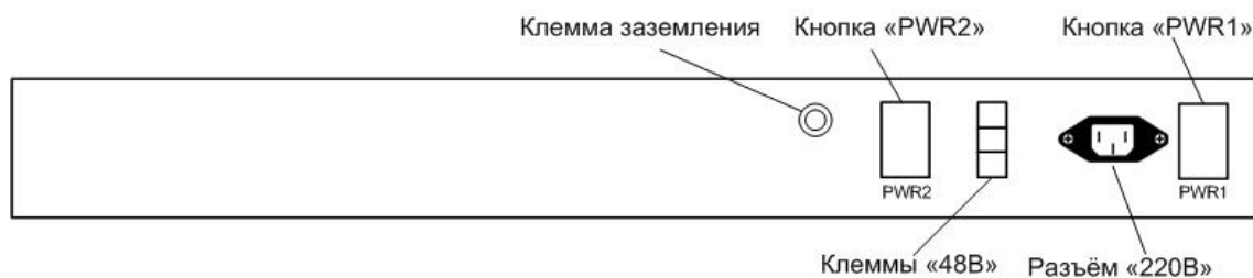
Рис. 2.6. Задняя панель FC-MRN-16E1/4Eth-AC/DC, V1, питание -48 В и ~220 В
