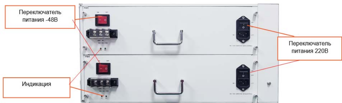
Рис.4.2 Задняя панель 5U с 20 слотами
