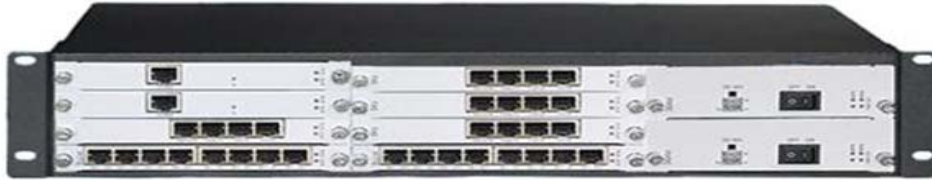
Рис. 2.1. Передняя панель NATEKS MMX-S, V1 (2,5U).
