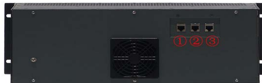
Рис. 2.1. Передняя панель NATEKS MMX-S, V1 (2,5U).
