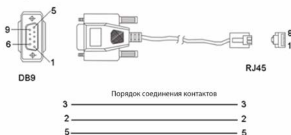
Рис. 4.9. Порядок соединения для кабеля DB9-RJ-45.
