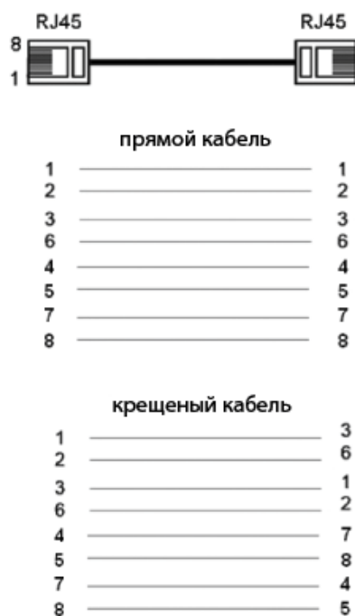
Рис. 4.2. Соединение с помощью прямого и крещеного кабелей.
