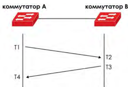
Рис. 8.9. Схема работы NTP.
