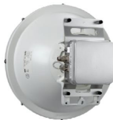
Рис. 5.2 ODU 13 – 38 ГГц с антенной 0,3 м.
