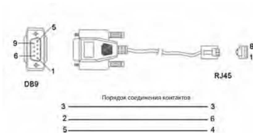
Рис. 7.7. Порядок соединения для кабеля DB9-RJ-45.
