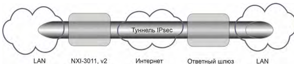
Рис. 4.30. IPsec VPN туннель с топологией сеть-сеть.
