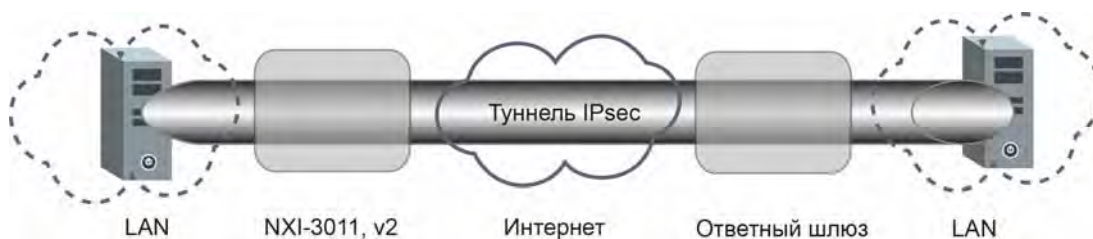
Рис. 4.21. Пример приложения хост-хост через соединение подсеть-подсеть.
