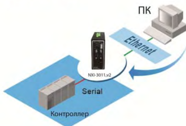
Рис. 5.2. Канальный режим NetXpert NXI-3011, v2 настроен как TCP-сервер.
