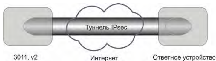
Рис. 4.17. Пример соединения хост-хост.
