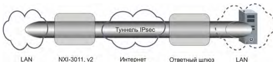
Рис. 4.20 Пример приложения хост-сеть через соединение подсеть-подсеть.
