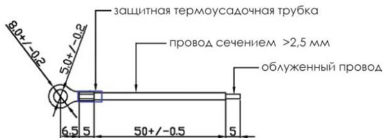
Рис. 3.10. Спецификация провода заземления (в мм)
