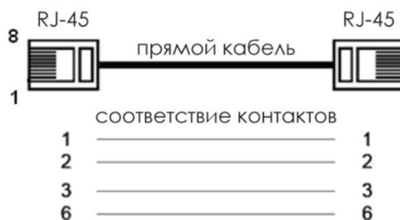
Рис. 3.6. Схема соединения (прямой кабель)
