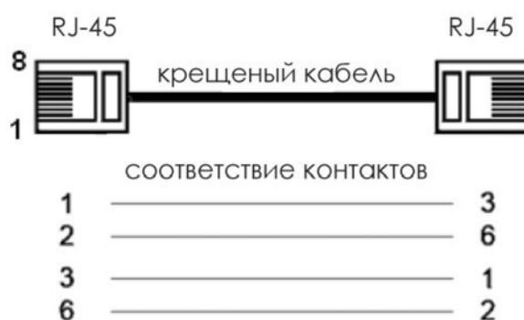
Рис. 3.7. Схема соединения (перекрестный кабель)
