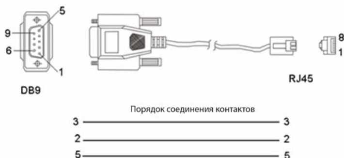
Рис. 4.11. Порядок соединения для кабеля DB9-RJ-45.
