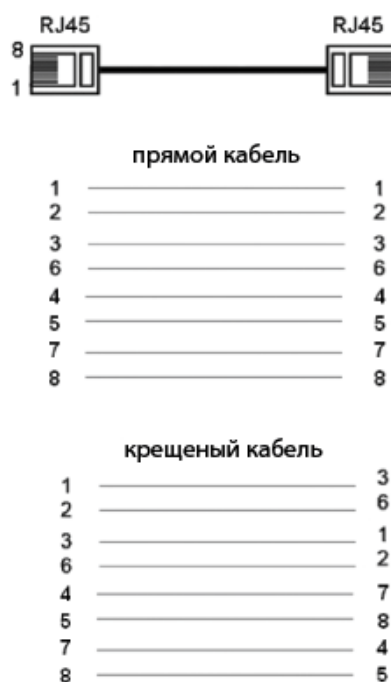
Рис. 4.4. Соединение с помощью прямого и крещеного кабелей.
