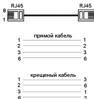
Рис. 4.2. Соединение с помощью прямого и крещеного кабелей.
