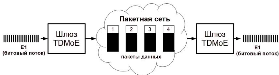
Рис. 1.1 Принцип работы шлюзов FC-TDMoE
