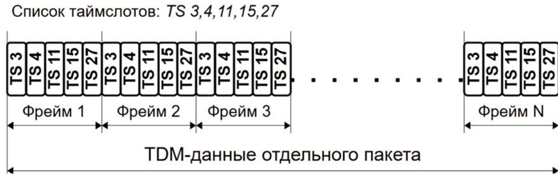
Рис. 5.5 Пример инкапсуляции данных фреймированного потока
